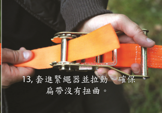
12, 將樹幹的扁帶末端穿過主軸。
